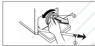
**2.** Выньте дренажную пробку (2), чтобы остатки воды стекли. Подставьте какой-нибудь сосуд, чтобы вода не попала на пол. Когда вода перестанет течь, откройте фильтр дренажного насоса (3), повернув его против часовой стрелки.
