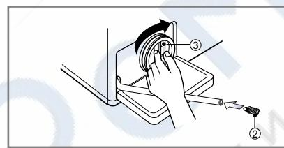
**4.** После чистки поверните фильтр (3) по часовой стрелке и вставьте на место дренажную пробку (2). Закройте дверцу на нижней панели.
