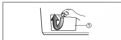
**1.** Откройте дверцу на нижней панели (1) при помощи монетки. Поверните дренажную пробку (2), чтобы освободить дренажный шланг.
